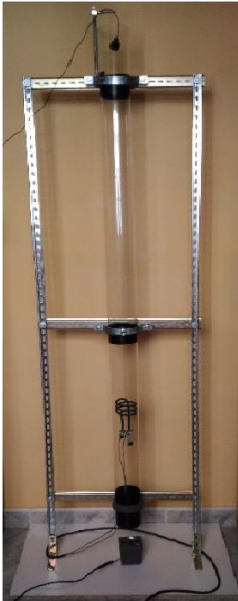
Figura 5. Montaje final del tubo de Rijke.
