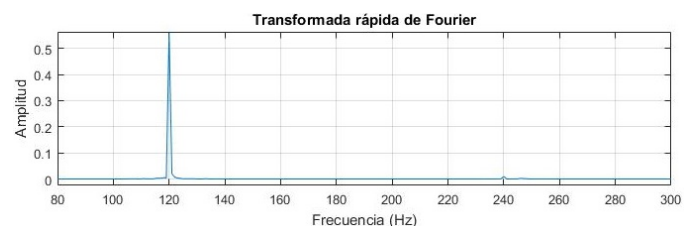
Figura 6. Transformada rápida de Fourier del sonido emitido.
