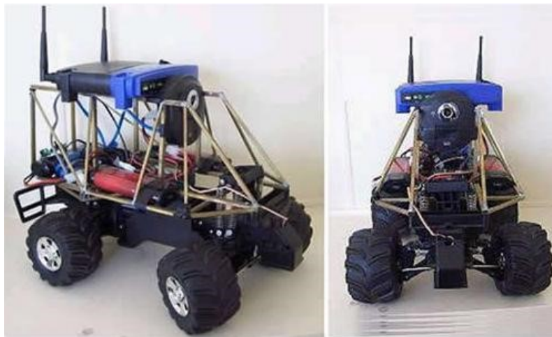
Figura 2.23: Robot con configuración Ackerman
