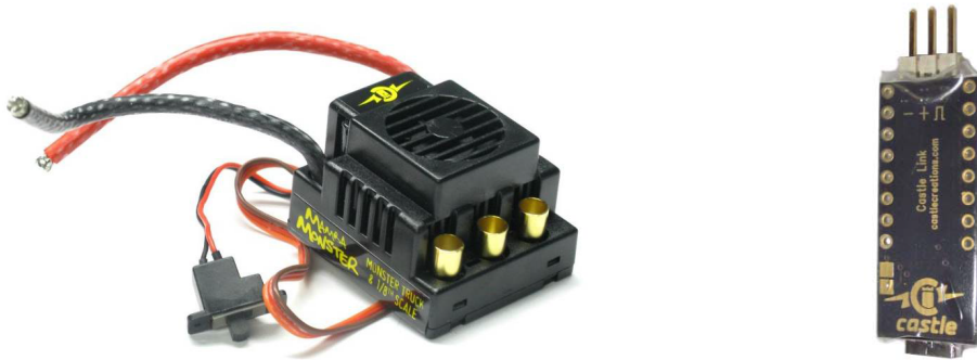
Figura 3.16: Drivers de los motores y programador Castle Link
