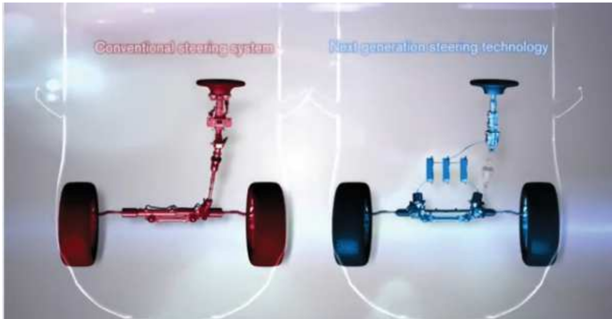
Figura 2.3: Comparación de un sistema de dirección tradicional y un sistema by-wire [4].
