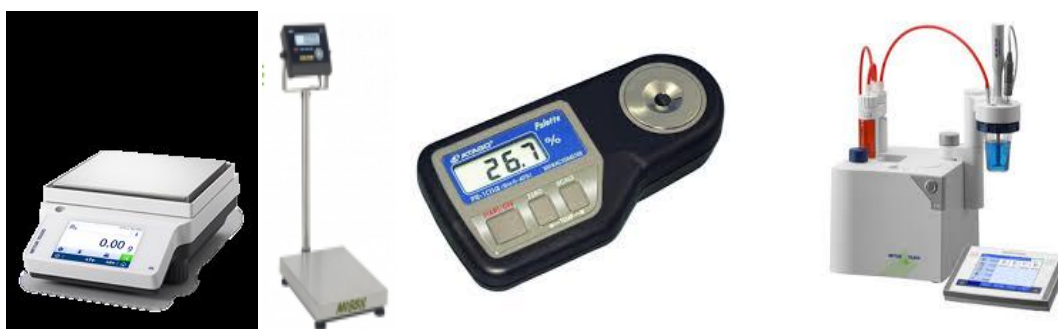
Imagen 4. Diverso aparataje utilizado para analíticas de frutos: balanza de precisión, báscula, refractómetro y equipo titración.
