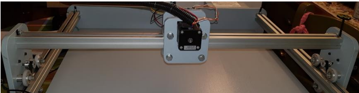
Figura 113. Detalle del empotramiento del otro perfil (650 mm)
