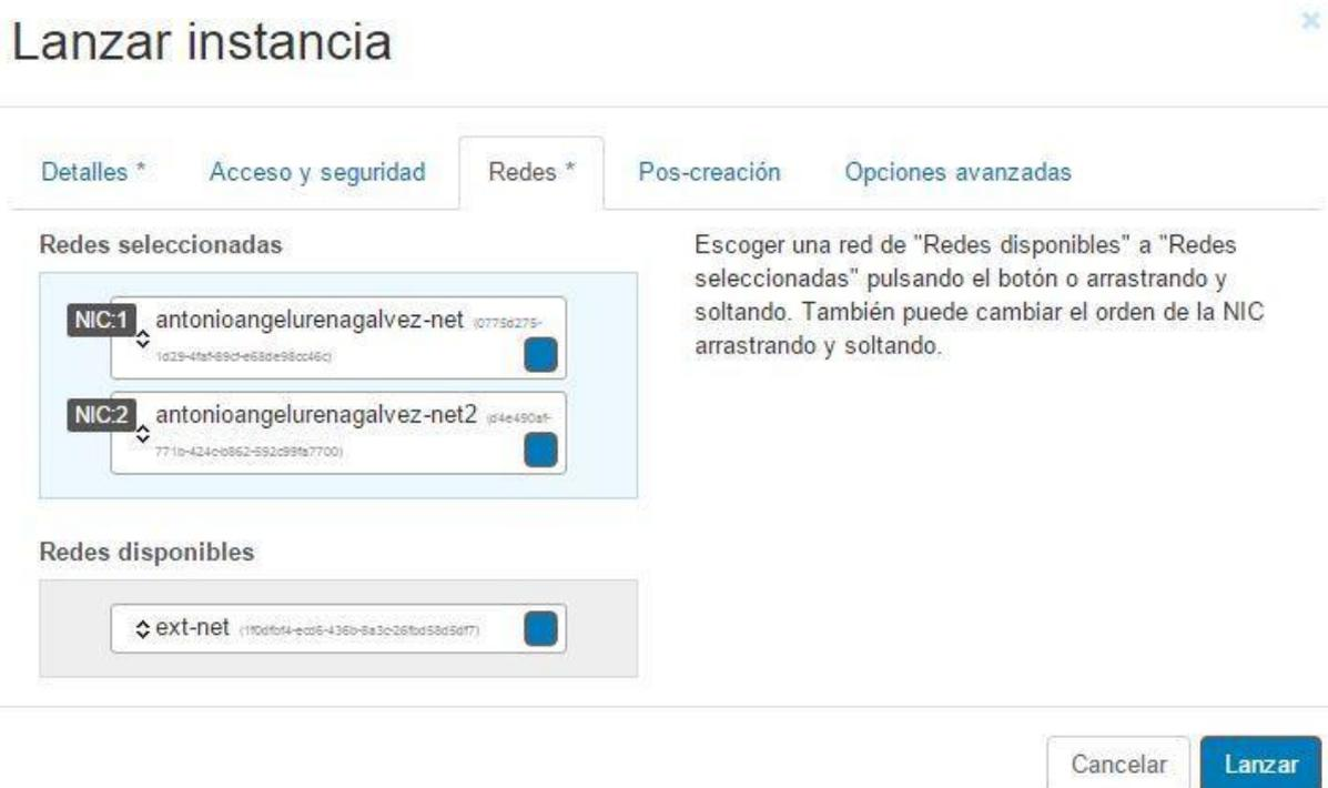
**Fig.7: Selección de las redes a interconectar de una MV en OpenStack.**
