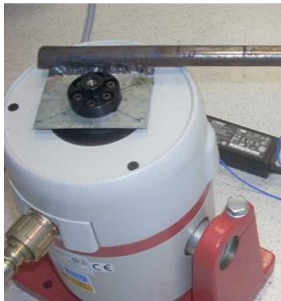
Figura 48. Antigo soporte y anclaje a mesa de vibraciones
