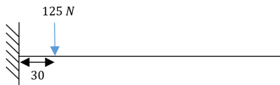
Figura 4-33. Diagrama de fuerzas plano XZ del eje de sujeción de los resortes.
