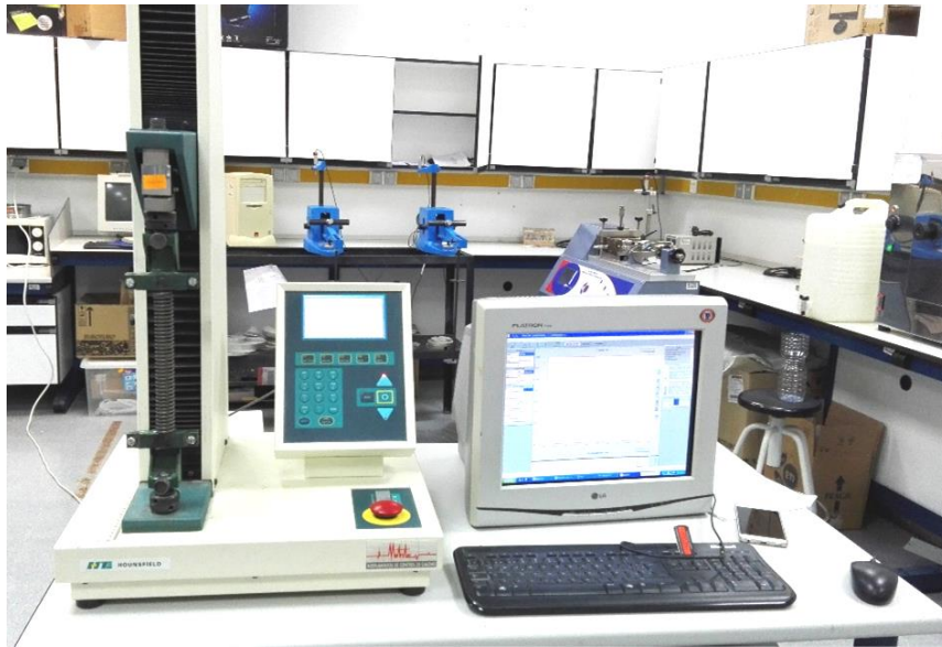
Figura A-8. Ensayo con equipo a tracción de los resortes.
