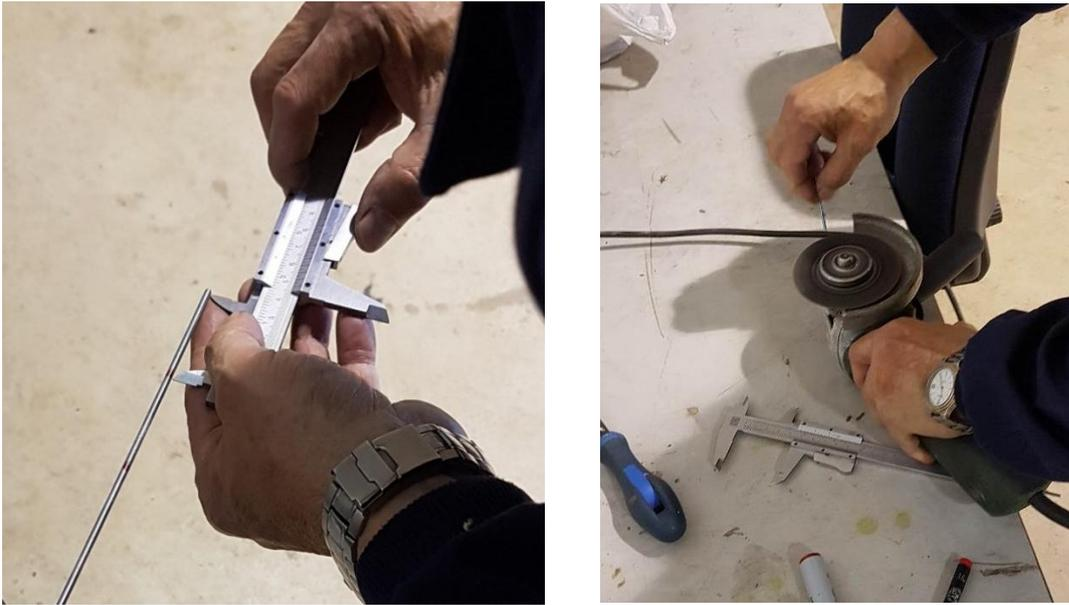
Fig. A.2 8 Medida y corte de varilla roscada.
