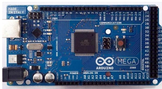
Fig. 2 51 Microcontrolador Arduino [57].
