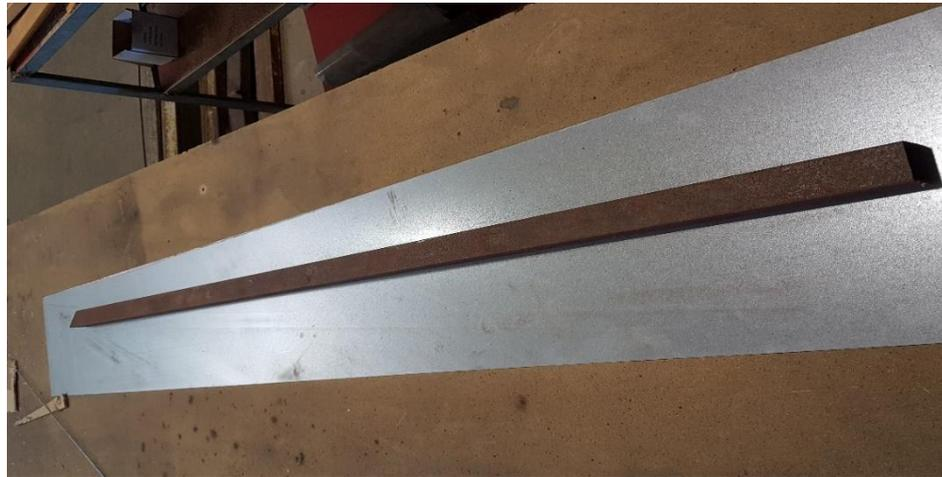
Fig. A.2 2 Tubo de acero 40x30x1.5
