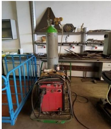
Fig. A.2 4 Soldadura con hilo.
