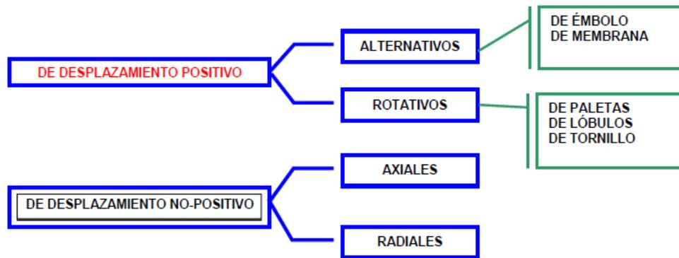
Fig. 2 38 Tipos de compresores.
