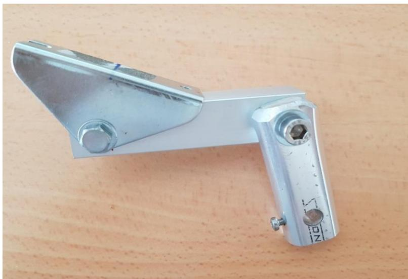
Fig. A.2 13 Mecanismo biela manivela.
