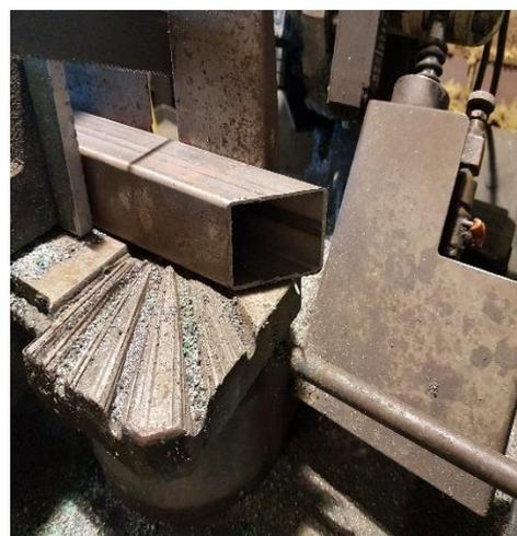
Fig. A.2 3 Máquina de corte eléctrica y corte de tubo.
