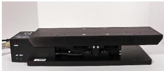
Fig. 2 8 Mesa de vibraciones Shake Table I-40 de Quanser [19].
