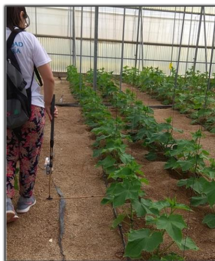
Figura 13. Monitorización de un cultivo de pepino con el sensor de reflectancia Crop Circle ACS-470.
