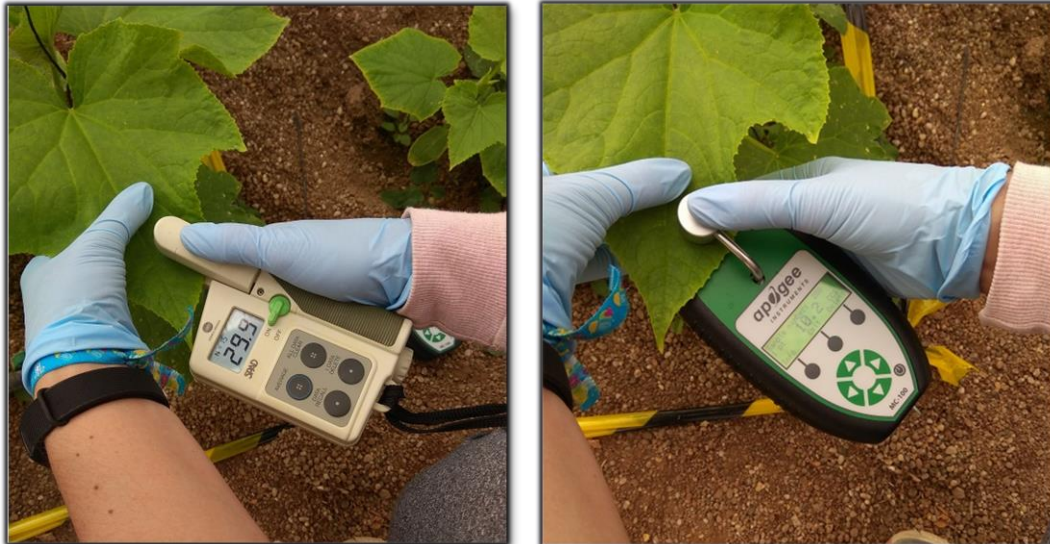
Figura 19. Medición realizada con el sensor SPAD-502, a la izquierda, y con el sensor Apogee MC-100, a la derecha.
