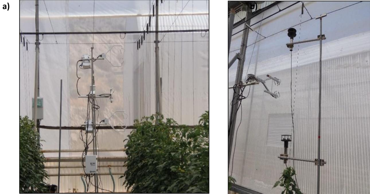
Figura 42. Anemómetros tridimensionales e IRGASON (a) para las medidas puntuales de velocidad del aire y anemómetros 2D para medidas continuas (b).
