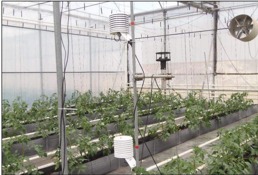
Figura 40. Sensores de temperatura y humedad con caja de protección de la radiación solar situados a 1 y 2 m de altura y anemómetro 2D para la medida de la velocidad del aire interior, en el centro del sector U11E delimitado por la partición con lámina plástica de la parte izquierda de la imagen.
