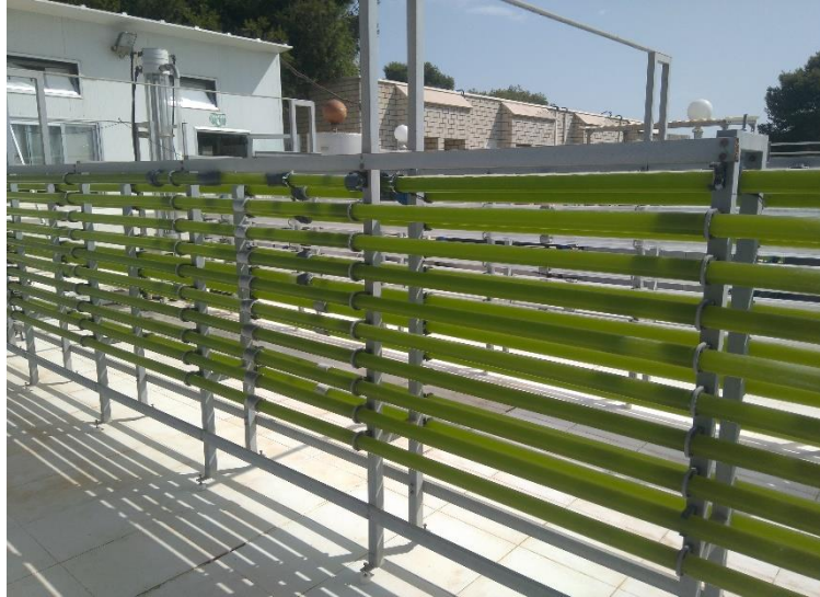
Figura 2. FBR tubular de metacrilato en la planta piloto de la Universidad de Almería.
