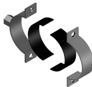
Figura 19. Despiece abrazadera isofónica
