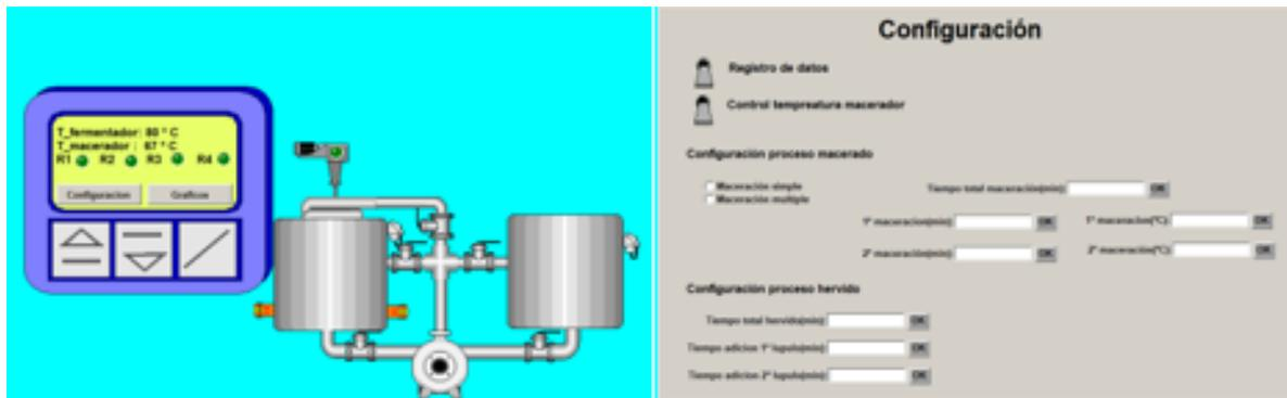
Figura 29. Interfaz gráfica para el control de temperaturas.
