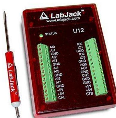
Figura 28. Tarjeta de adquisición y control de datos LabJack U12.
