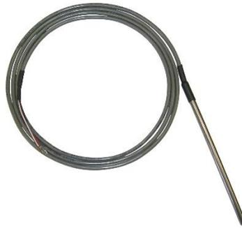
Figura 26. Sonda de temperatura tipo PT100 de acero inoxidable.
