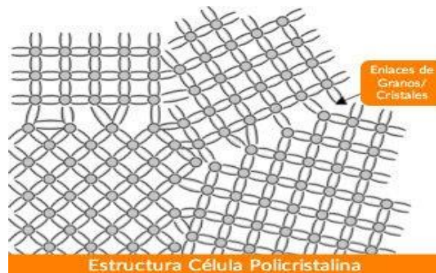
Figura 9 Estructura de una célula policristalina. (Fuente: https://www.sfe-solar.com )
