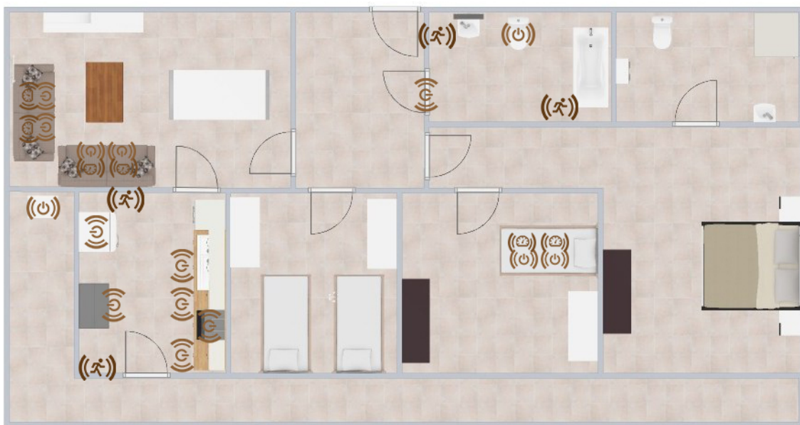
Figura 5.10: Ubicación de los sensores en la vivienda
