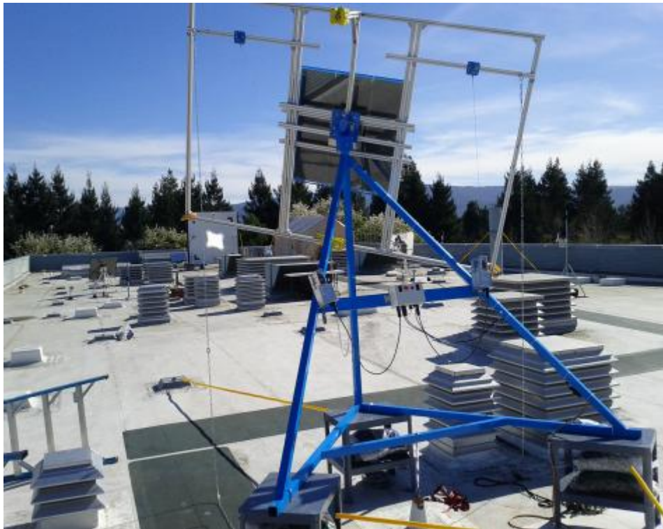
Figura 1.12: Un heliostato prototipo manteniendo la luz en el objetivo. [23]
