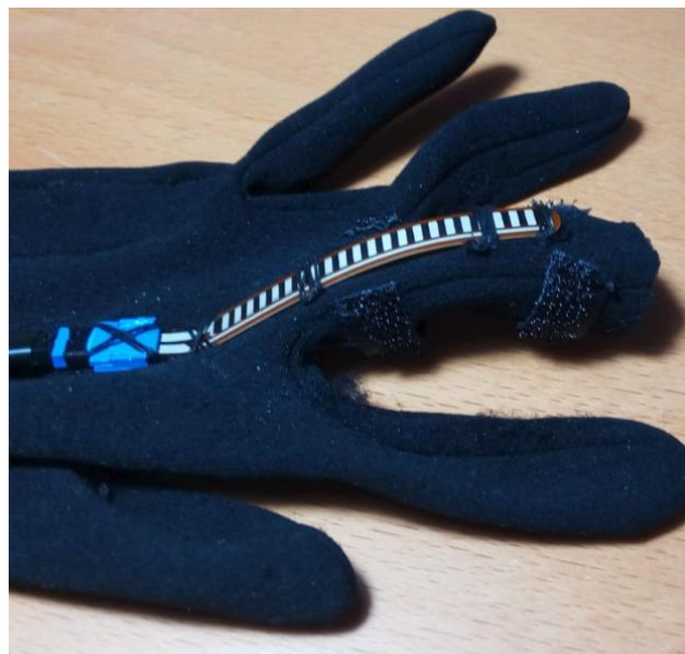
Figura II-33: Detalle de las tiras de velcro en el dedo
