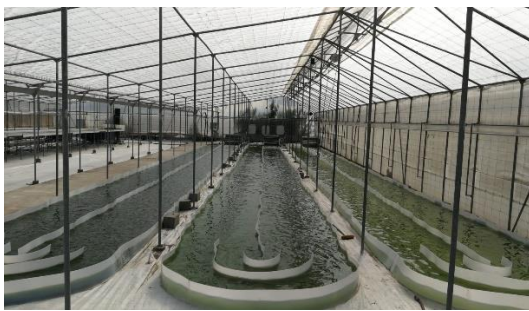
a. Raceways de 90 m 2
