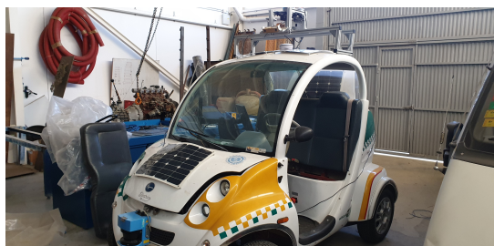
(b) Vehículo con los paneles solares instalados
