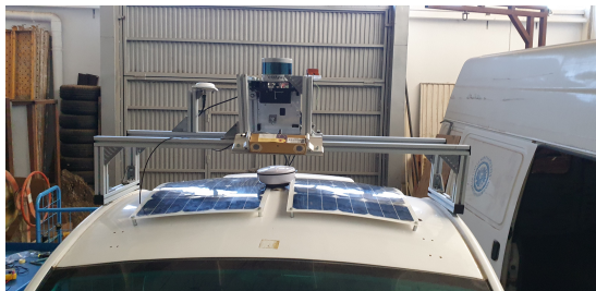
(c) Paneles superiores instalados
