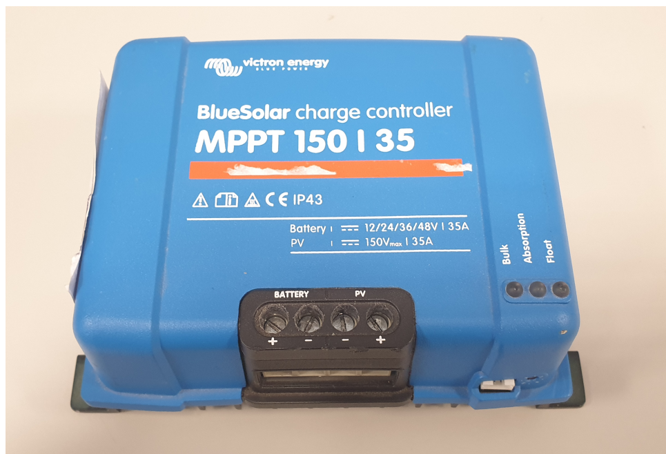
Figura 3.8: Regulador de carga MPPT de Victron Energy, modelo de 150 V y 35 A
