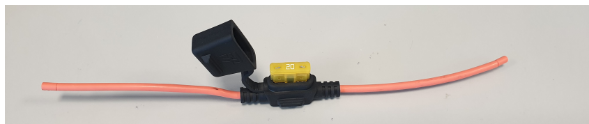
Figura 4.13: Fusible de 20 A instalado en el sistema de baterías del vehículo
