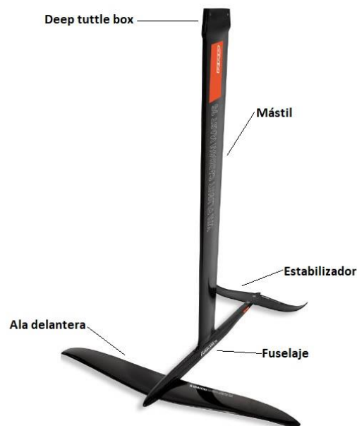
Figura 45. Elementos de un hydrofoil
