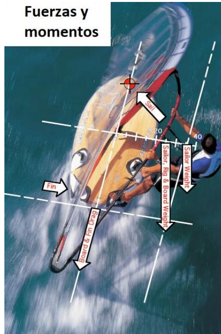
Figura 18. Fuerzas y momentos en el windsurf. [6]
