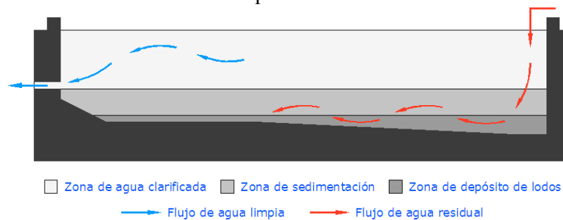
Figura 8. Balsa de decantación. Zonas y flujos. Fuente: (Rodríguez et al., 2008) [11].
