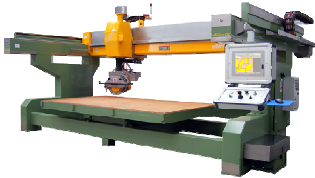
Fig. 4. Cortadora para despieces con movimiento longitudinal y transversal.
