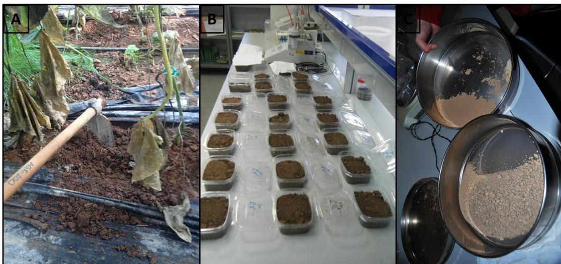
**Figura 3.** Recogida de muestras de suelo(A), secado de las muestras en el laboratorio (B) y tamizado de las muestras (C).
