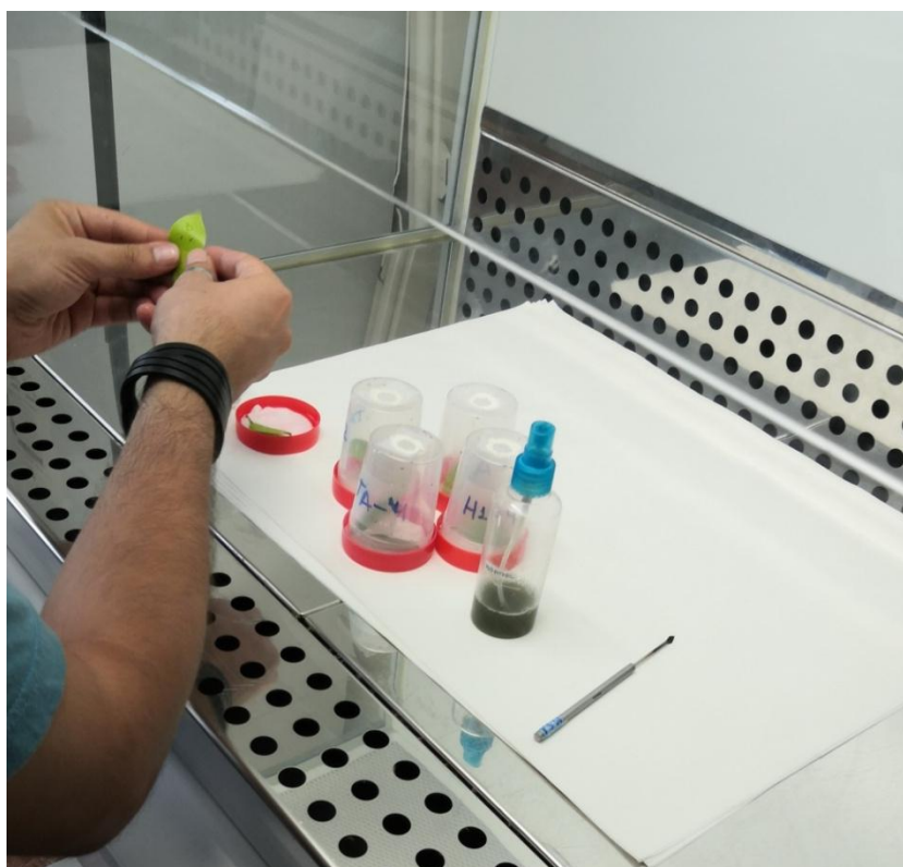
Imagen 36: Pulverización de los hongos entomopatógenos en la campana de extracción mediante un pulverizador.
