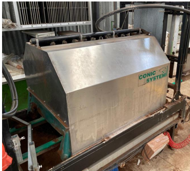
Ilustración 7: Túnel de riego.
