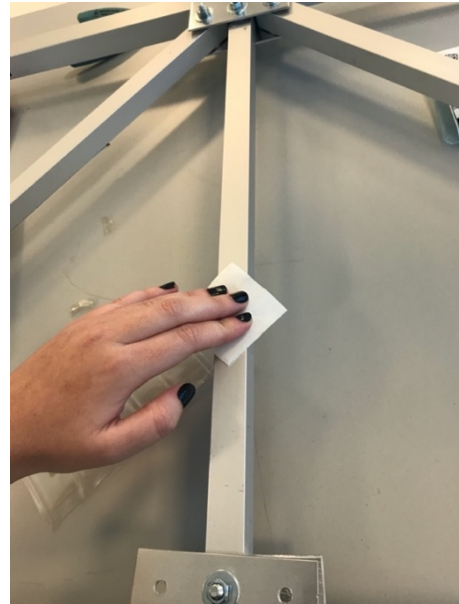
Figura 4.24. Desengrasado de la superficie
