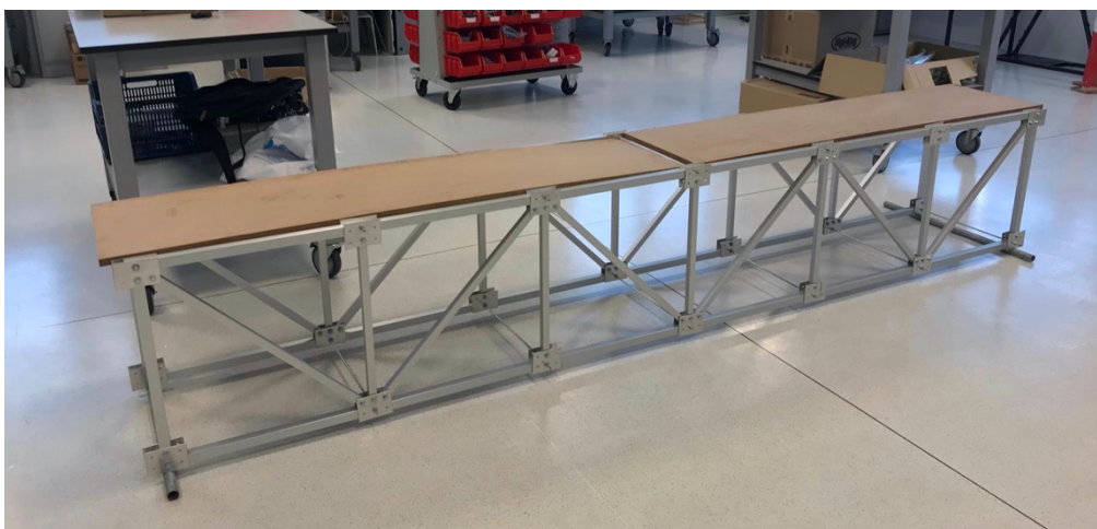
Figura 5.21. Maqueta de un puente formado por una estructura en celosía del laboratorio.
