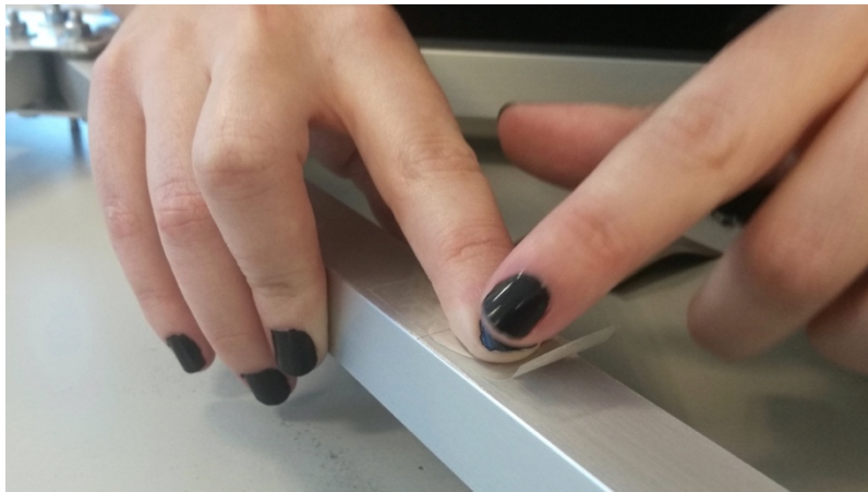
Figura 4.32. Aplicación de presión sobre la galga y el adhesivo
