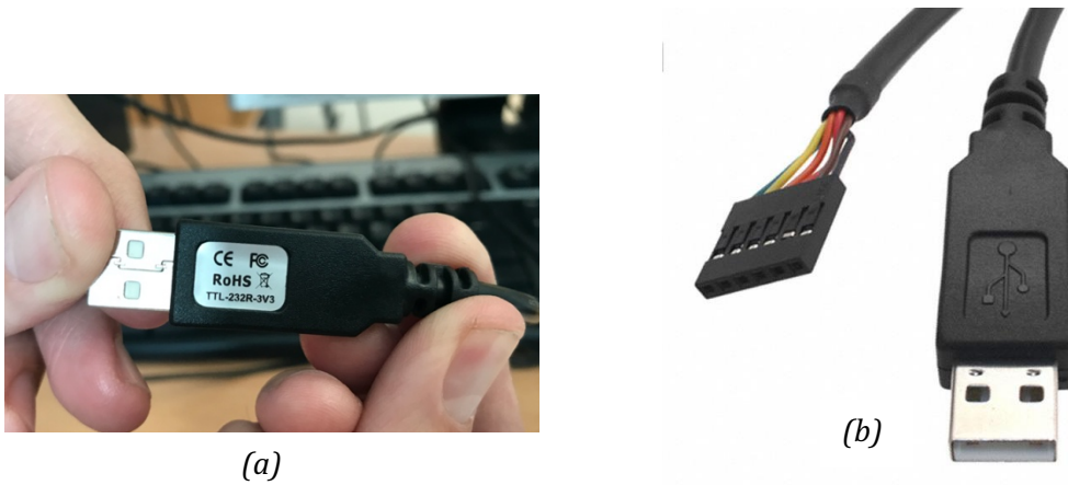
Figura 4.37. Cable TTL-232R-3V3 (a) disponible en el laboratorio y (b) imagen proporcionada por el fabricante
