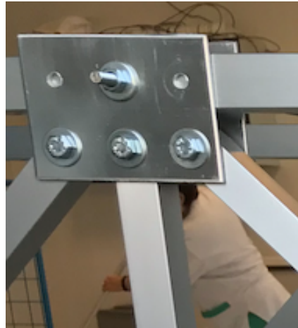
Figura 3.8. Un nudo articulado de la maqueta de la UAL
