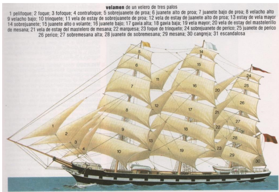
Figura 1.3. Velamen de un velero de tres palos. Fuente: Enciclopedia Larrousse.
