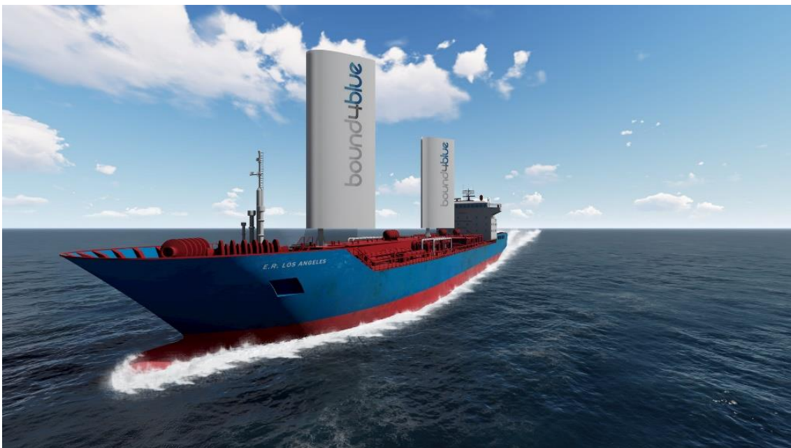
Figura 1.13. Imagen renderizada de un buque con las velas Bound4Blue instaladas. Fuente:bound4blue.com
