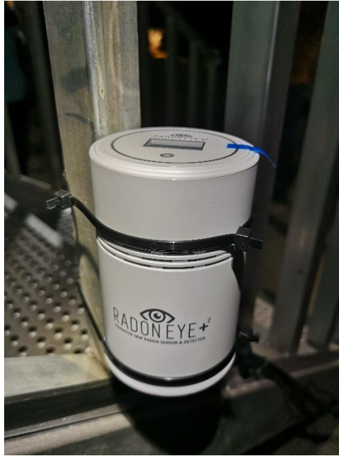
Figura 3: Sensor de radón situado en uno de los cuatro puntos de medición.
