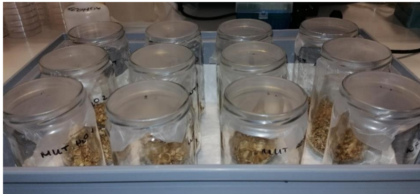
FIGURA 10. Preparación en botes de cristal, con 5 gramos vermiculita y 20mL de la solución correspondiente.
