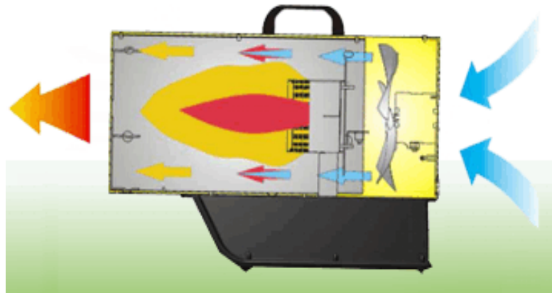
Figura 2.26 Esquema de funcionamiento de generador aerotérmico [33]
