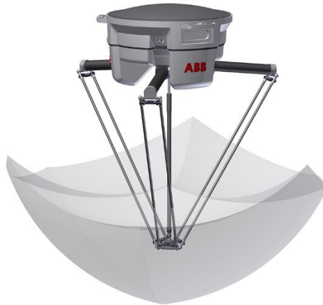
Figura 20: Representación del volumen de trabajo del robot paralelo ABB IRB360 FlexPicker.
