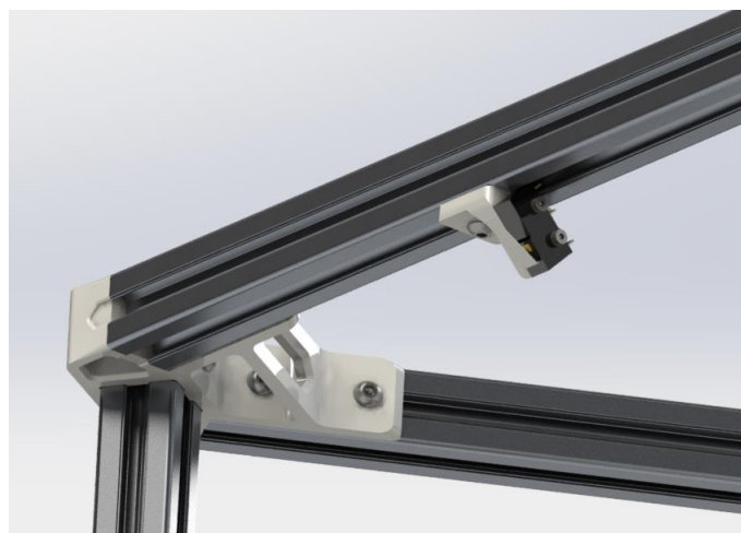
Figura 63: Detalle ensamblaje final de carrera prototipo SolidWorks®.
