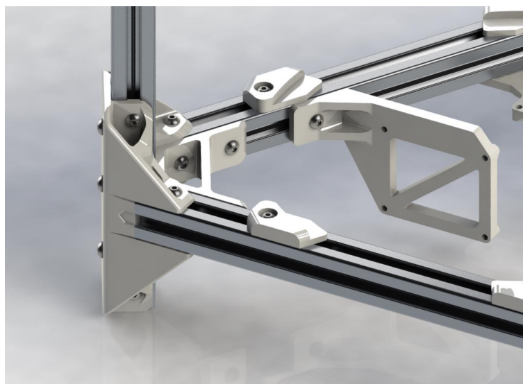
Figura 67: Diseño soporte mosfet externo cama caliente SolidWorks®. Fuente: Elaboración propia.
