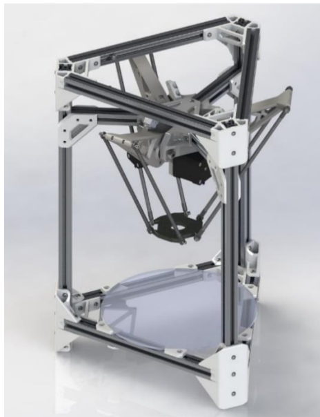
Figura 13: Diseño impresora 3D basada en robot paralelo tipo delta.
