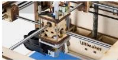
Figura 11: Tipos de impresoras de arquitectura cartesiana.
