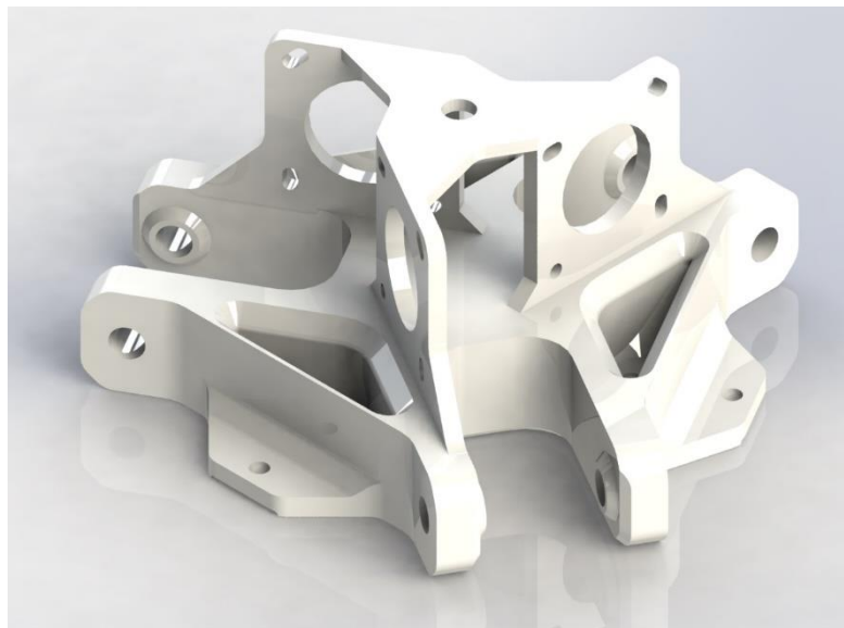
Figura 29: Detalle del soporte del cuerpo del robot del prototipo RoPar3D.
