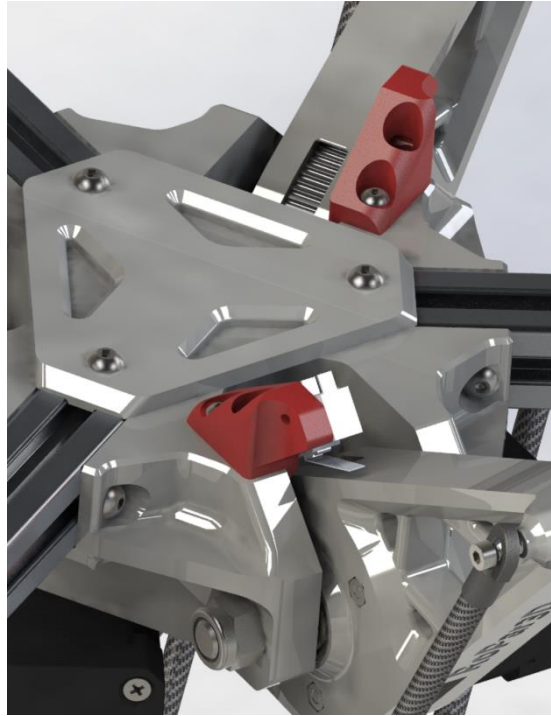
Figura 64: Detalle ensamblaje final de carrera SolidWorks®.
